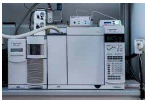
Strumentazione GC/MS con desorbitore termico e porta sniffer
