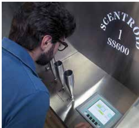
Olfattometro a diluizione dinamica Scentroid SS600, con 3 bocchette (sniffer) e touchscreen per le risposte del valutatore
