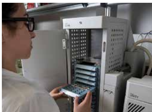
Fase dell'analisi di speciazione GC/MS: caricamento del campionatore
