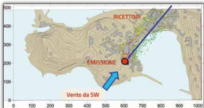
Uso del modello Spray per consulenza progettuale, al fine di valutare i presidi di abbattimento delle emissioni odorigene più idonei a mitigare l'impatto olfattivo
